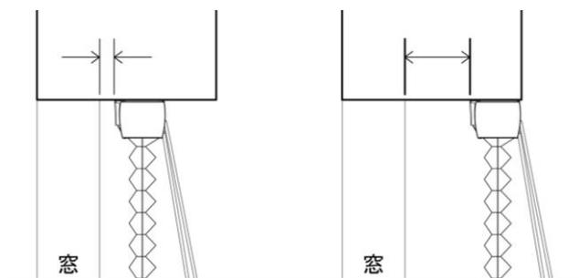
②ドリルで道穴を開け、ブラケットを両面テープで貼り付けて固定しながらビスを打って取り付ける
