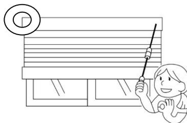
スクリーンを降ろす際には、スクリーンが降りきるまで操作コードを手から離さないでください。操作中にコードを離した場合、勢いよくスクリーンが下がり、ブラインドの破損や不具合、窓枠や床面を傷つける可能性があります。
