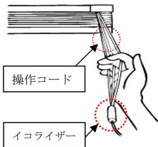
開閉を繰り返すうちに、操作コードに絡み（ねじれ）が生じる場合があります。その際は、髪をとかすように操作コードの絡みを整えてください。コードの絡みが多い状態で使用し続けると操作が重くなったり、コードが摩耗しコードが切れてしまう可能性があります。お客様が安心してご使用いただくために定期的なコードの絡みを整えるメンテナンスを実施するよう必ずご説明ください。
