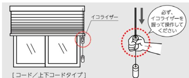
コードタイプ/上下コードタイプのイコライザーは、一定の荷重が加わるとイコライザーが外れる安全対策品です。その為、操作時に少し乱暴に扱うとイコライザーが外れる場合があります。操作をするときは、必ずイコライザーを握って操作をするようお願いします。
