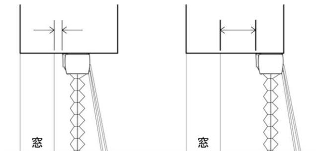
2.ドリルで道穴を開け、ブラケットを両面テープで貼り付けて固定しながらビスを打って取り付ける
