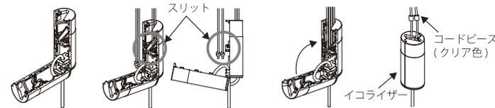
コードビーズは、イコライザーが外れた時に操作コードが上部レール内に入ることを防止します。また、コードビーズは、イコライザーより上に露出するようにセットしてください。
