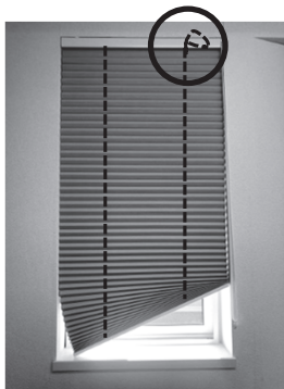
内部でコードが絡まっている状態
