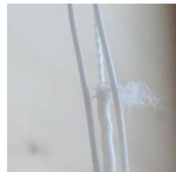
○操作コードの絡み（ねじれ）が解消できない場合は、イコライザーを外して操作コードの絡み（ねじれ）を整えてからご使用ください。
