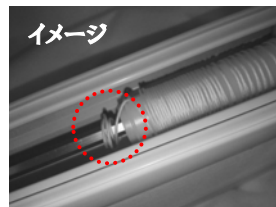
（上部レール内：スプール＜糸巻き部分＞からコード脱落、絡まり）
