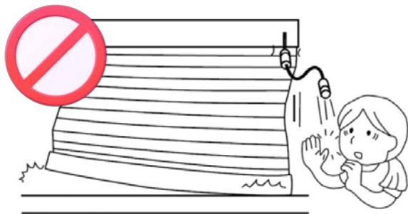
首吊り事故等を防ぐため、イコライザーは、以下のような荷重をかけると操作コードが外れる仕組みになっております。故意に荷重をかけないでください。
