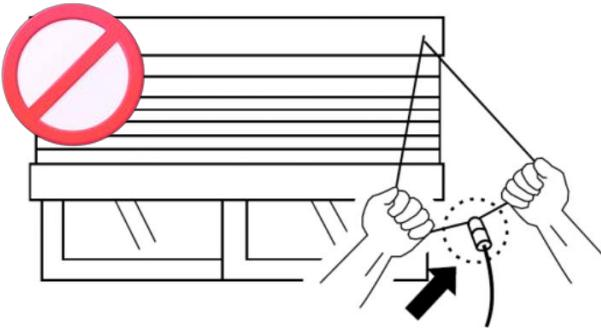
コードタイプ・上下コードタイプ・ツインコードタイプのブラインド昇降の際には、必ずイコライザー部分を握って操作してください。
