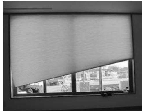
ループコードタイプは、操作コードを回すことによってスクリーン内のコードが上部レール内のスプールに巻き取られ、ブラインドを上げ下げすることができる構造となっております。操作中に傾きが発生する場合は、内部コードに絡まりや引っかかりが発生している可能性があります。窓枠(下部)や障害物に接した状態で閉める操作を続けると生地全体の均一な荷重を受けることができずスプールの糸巻き部分に不具合(コード脱落・絡まり)が生じる可能性があります。また、**故意に下部レールを持ち上げた状態で開閉操作を行わないでください。**
