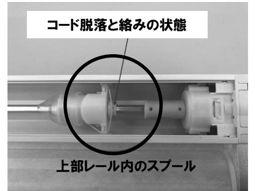
④内部でひっかかりができてしまうと、下の画像のように、操作した際にレールにひっかかった長さ分の傾きが出てしまいます。
